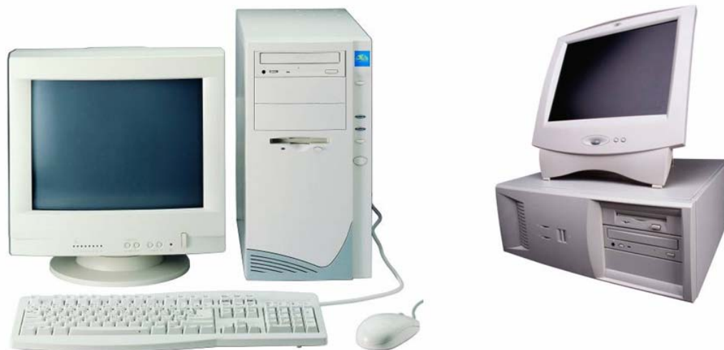
1.2.1-расм. Компьютер тизимли блоклари турлари: tower (чапда) ва desktop (ўнгда)
